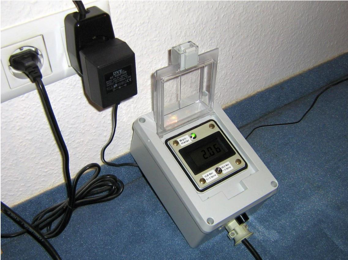
Abbildung 6.11: Wirkleistungsmessgerät in Betrieb
