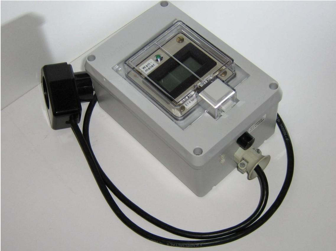
Abbildung 6.10: Fertig aufgebautes Wirkleistungsmessgerät
