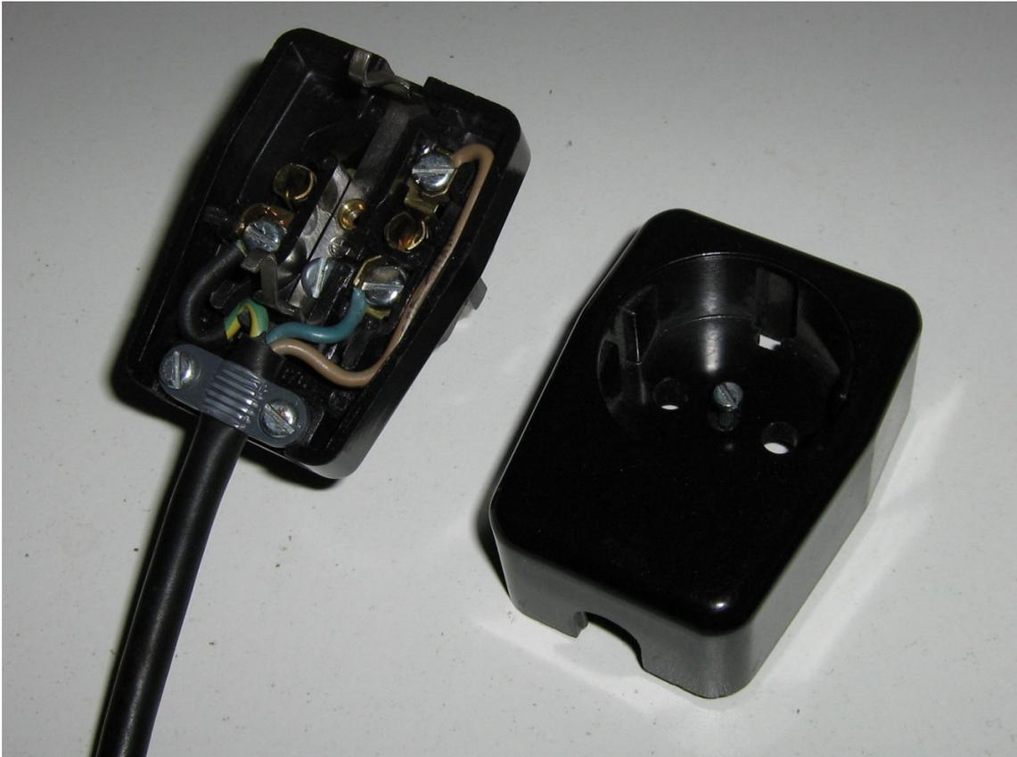
Abbildung 6.9: Anschluss des Zwischensteckers
